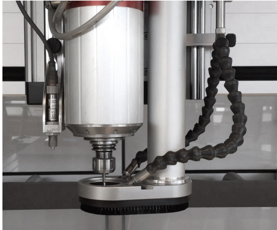
Der Saugschuh der vhf-Aluminium-Absaugvorrichtung an einer Drehstromspindel SPC 1500P. Durch zwei Einlässe wird während des Absaugens Kühlflüssigkeit über die vhf-Minimalmengenschmierung zugeführt.
