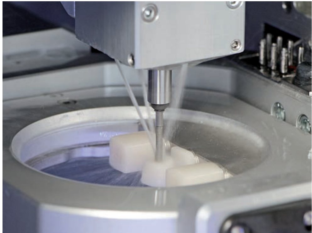
Detailansicht des Nass-Schleifens von Glaskeramik auf einer CAM 5-S1 Impression: aus drei Düsen wird Flüssigkeit auf die Werkzeugspitze geleitet.
