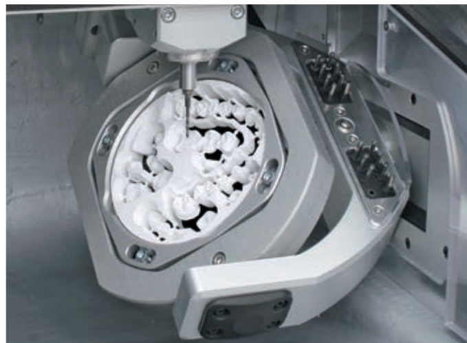
Detailansicht des Innenraums einer CAM 5-S1 Impression mit schräggestellten Achsen, rechts auf der B-Achse befindet sich der Werkzeugwechsler mit 16 Stationen.
